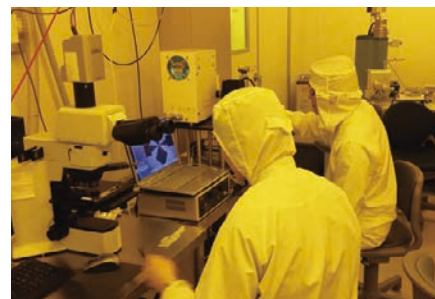
クリーンルーム（イェロールーム）内での半導体微細加工プロセスの様子
