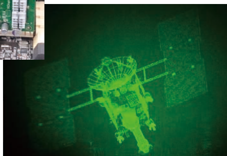
三次元映像技術ホログラフィを電子的に利用した三次元テレビの研究：左段は研究室で開発した専用コンピューターボードで、右段は人工衛星の三次元動画のワンショットです。
